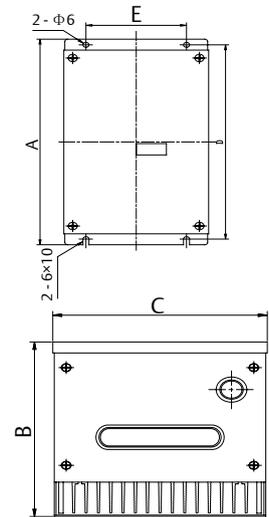
EV5000-4T0900G ~ EV5000-4T2200G变频器请使用多个制动单元(TDB-4C01-0550)并联运行。
