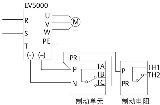
TA – TB、TA – TC为故障继电器触点；TH1、TH2为温度继电器触点。
